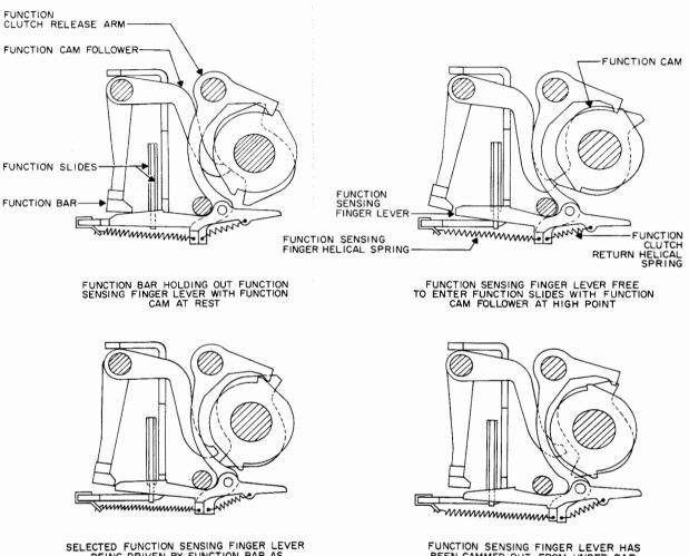
SELECTED FUNCTION SENSING FINGER LEVER BEING DRIVEN BY FUNCTION BAR AS FUNCTION CAM FOLLOWER DROPS. FUNCTION CLUTCH RELEASE ARM HAS RELEASED SELECTED FUNCTION CLUTCH
