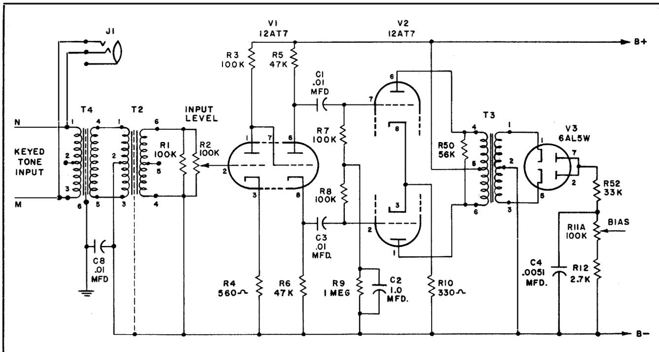
Figure 2-3. Amplifier-Rectifier Circuits
