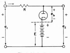
Fig. 3. Diode clipper.
